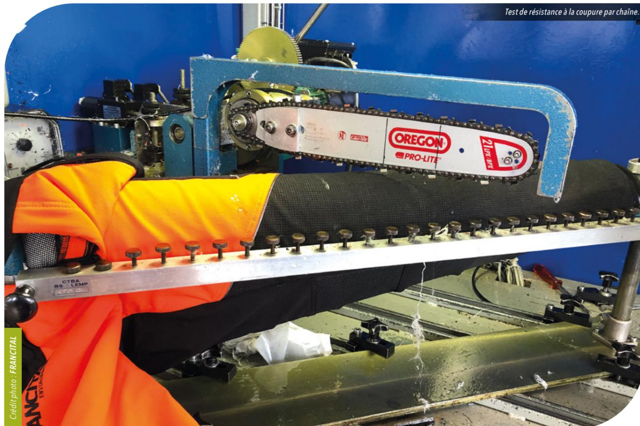
Test de résistance à la coupure par chaîne.
